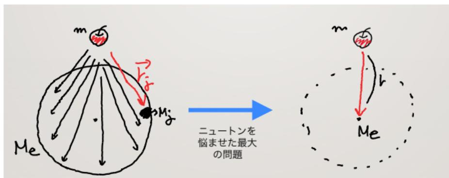
図 4: 地球の重力は、全ての質量が中心に集中した質点による万有引力に等しい
