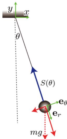
図 3: 振り子系．重りに掛かる力を図示した．重りは糸からの張力により， $\mathbf{e}_r$  に対して負の方向に引っ張られる．
