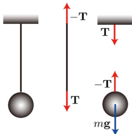
図 1: (左) 天井から吊り下げられた、糸と重りからなる振り子. (中央) 糸にかかる力. 両端を引っ張る方向に張力. (右) 天井と重りに働く力.
