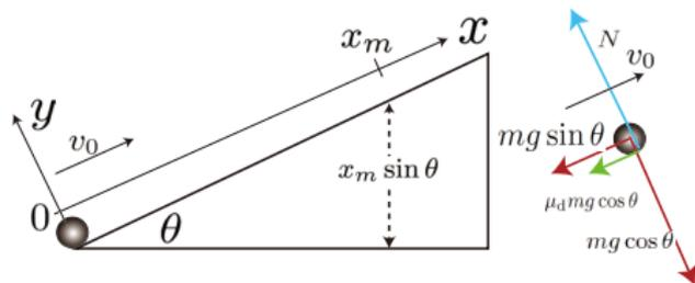
図 4: 本例題の設定図. 右図に (1) において質点に働く力を図示した.
