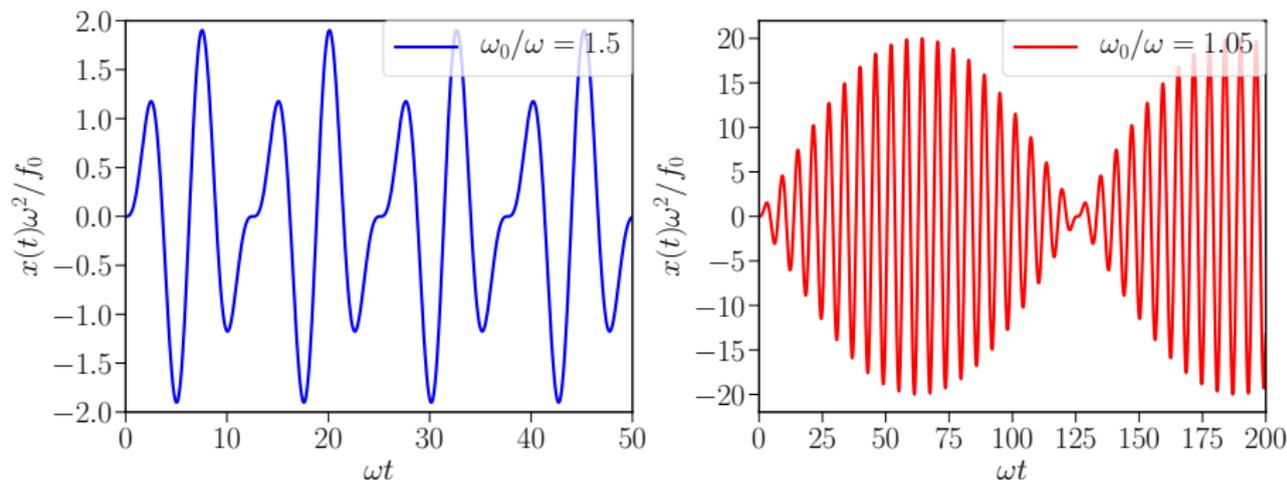
図 2: 強制振動の特殊解：式 (14) の時間依存性. (左)  $\omega_0/\omega = 1.5$  の時. (右)  $\omega_0/\omega = 1.05$  の時.  $\omega$  と  $\omega_0$  が近い時は、うなりの様子が見て取れる. ここでの短周期振動の周期  $T_1$  は  $\omega T_1 = 4\pi\omega/(\omega_0 + \omega) \sim 6.1$ , 長周期振動の周期  $T_2$  は,  $\omega T_2 = 2\pi\omega/(\omega_0 - \omega) = 40\pi \sim 125$  となる.
