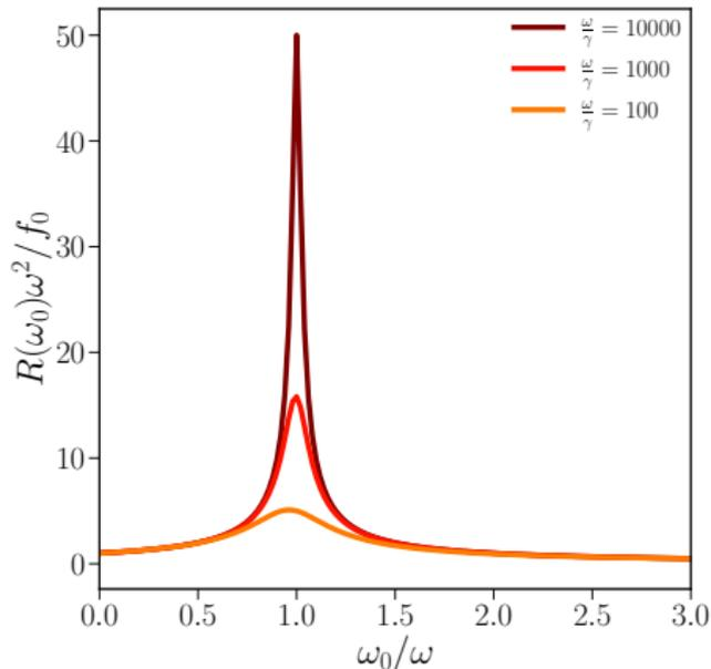
図 4: 振動振幅  $R(\omega_0)$  の外力の振動数  $\omega_0$  依存性. 不足減衰条件の様子を图示したもの.  $\omega/\gamma$  が大きいとき  $\omega_0 \sim \omega$  で  $R(\omega_0)$  はピークを示す. ただし厳密には, ピーク位置は  $\omega_0^* = \sqrt{\omega^2 - 2\gamma^2} = \omega\sqrt{1 - 2(\gamma/\omega)^2}$ .  $\omega/\gamma$  の減少にともないピークが低振動数側にシフトし, その高さは低くなる.
