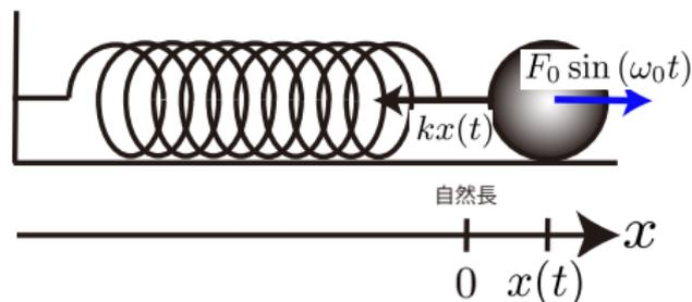
図 1: 強制振動させた質点に関する座標系.
