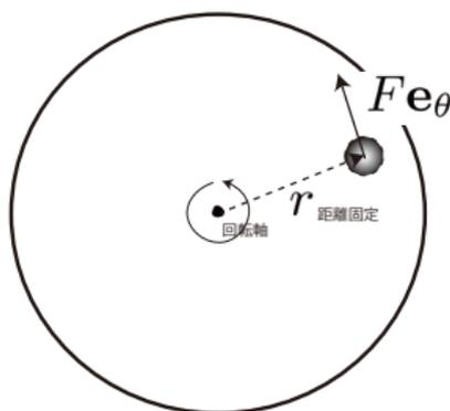
図 1: 円板上に固定された質点の運動. 円板の中心を回転軸とし、質点の回転接線方向に力  $F$  を与える.
