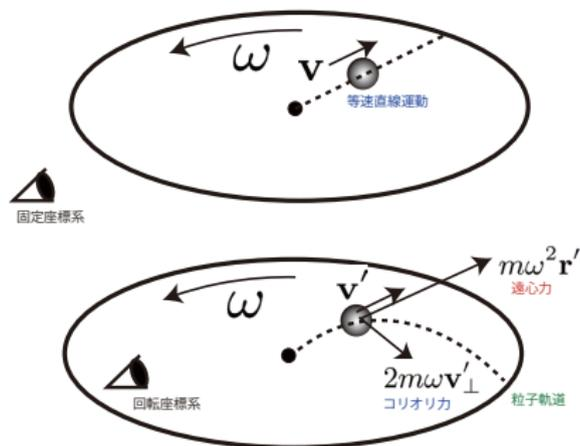
**図 7:** 固定座標系 (上) ではまっすぐ進む等速直線運動の場合、回転座標系 (下) においては、慣性力 (遠心力とコリオリ力) によって、軌道は進行方向に対して右方向に逸れていく。但し、外力はかかっていないとする。この現象を平易に言い換えると、台の外から物体の運動を見ると等速直線運動であるが、台の上から同じ運動を見ると、進行方向に対し右側に逸れていくように見える。右側に逸れる為には何かしらの力が必要で、これこそが慣性力である。
