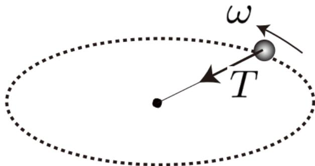
図 3: 長さ  $l$  の糸の一端を固定し他端に質量  $m$  の重りを取り付けこれを等角速度  $\omega$  で回転運動させた系の設定図.
