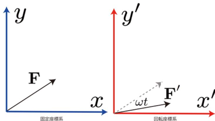
図 6: 同じ力を固定座標系と回転座標系で見た時の違いについて. 回転座標系でみると偏角が  $\omega t$  小さくなったように見える.
