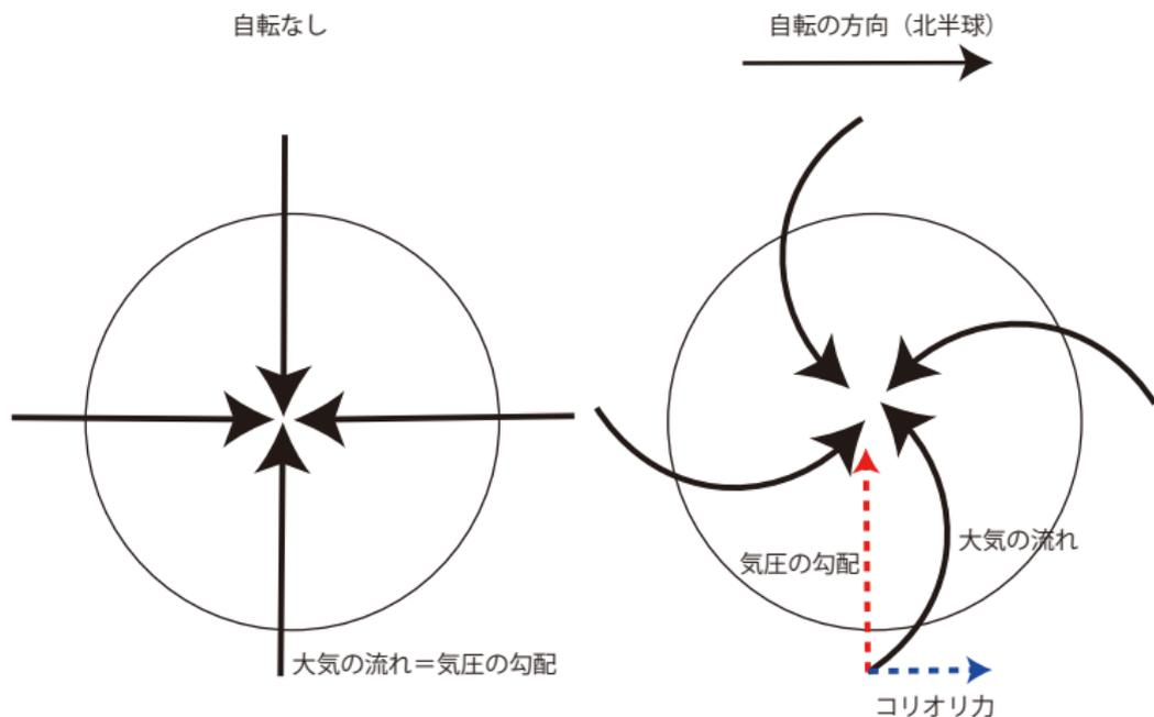
図 4: 台風の渦形成の原理. 自転がないと (左図), 大気は常に台風の中心へまっすぐ流れる. 自転があると, コリオリ力により, 大気の流れが進行方向右方向にずれる (右図: 北半球の場合).
