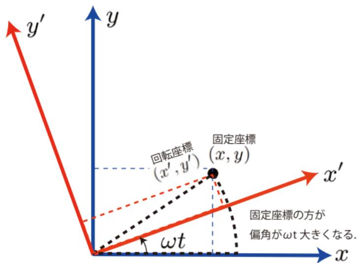
図 5: 固定座標系  $(x, y)$  と回転座標系  $(x', y')$  の関係。同じ点に対して固定座標系の方が  $\omega t$  だけ偏角が大きくなる。
