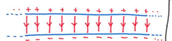
コンデンサの外を回、て電荷を運ぶ場合を電場の力に逆ら、て運ぶるで仕事が必要、
