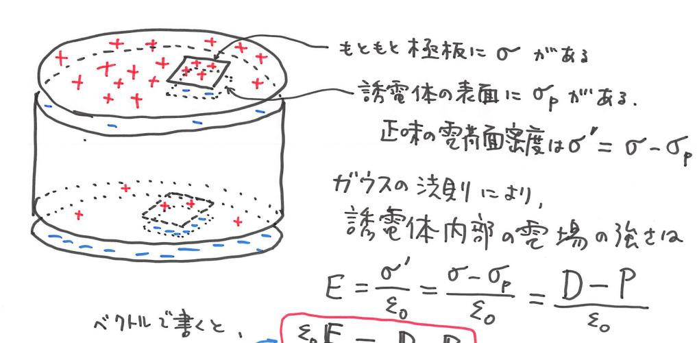
分松場Pのせいで、 電車Dの一部が吸収を取れて Eが弱くなることを表している。 統形応答物質 近似的経験則 P= Xe E。E Xe: 物質の電気感受率(無次元) 電標度の新たな定義式 D:= E。E + P
