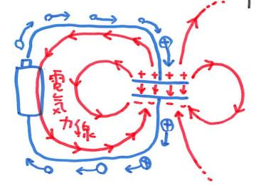
実際の有限サイズのコンデンサジョ 等体板の外でも電場はリンゼロ.
