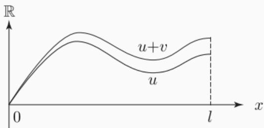
図 4.4: ポテンシャルエネルギー最小原理で使われる変位  $u$  と任意変動  $v$
