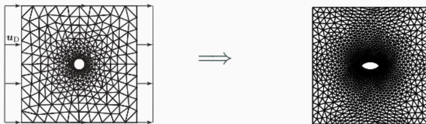
(b) 2次元 Stokes 流れ場の平均流れ抵抗最小化
