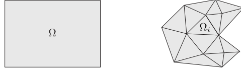
(a) \Omega : 6.1 節の Galerkin 法 (b) \{\Omega_i\}_i : 有限要素法
