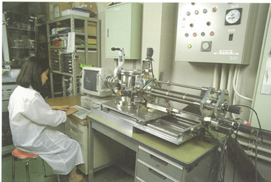
自動試料交換装置 コンピューター制御により、自動的に測定試料を交換する。
