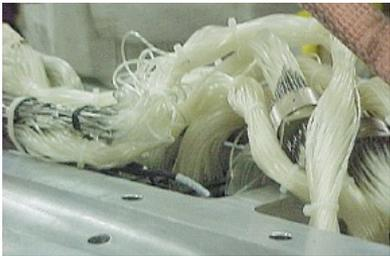
左の写真には、翼表面に開けた穴と、それぞれの穴につながった細いビニールチューブの束が写っている
