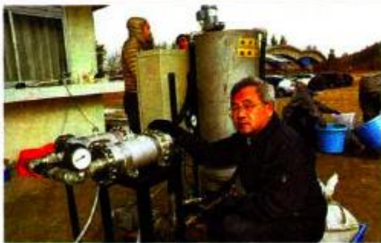
放射性物質を含んだ土をろ過する装置
