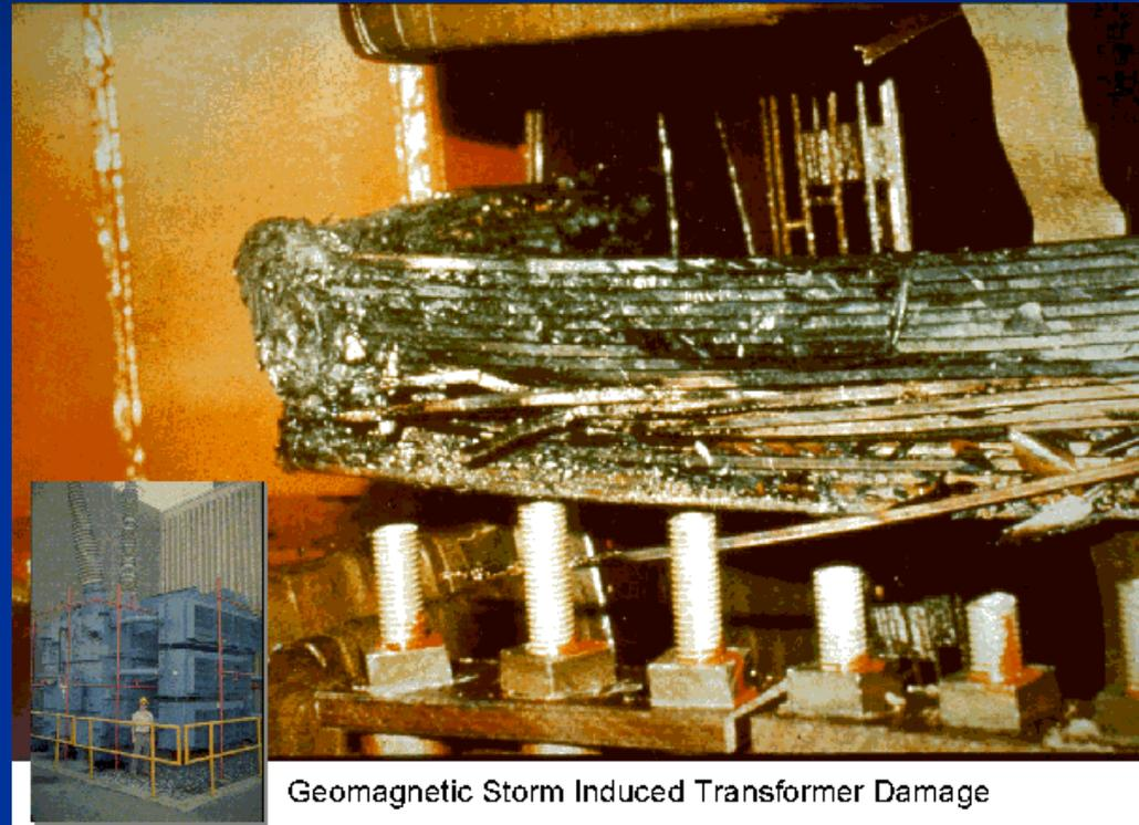
米国東部の発電所で焼損した変圧器
