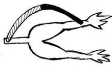
ガルバーニによれば電気は筋肉内にあるとされたが、残念ながらカエルが電気を持つのではなく、2種類の金属とカエルの足を環状に接続すればいつでもカエルは痙攣した。電源はカエルではなく2種の金属だったのである。
