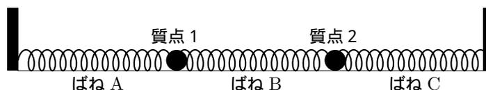
という状況を考えよう。質点 1 の変位を  $x$  で、質点 2 の変位を  $y$  で表し、それぞれのばねのばね定数を  $a, b, c$  とすれば、運動方程式は、
