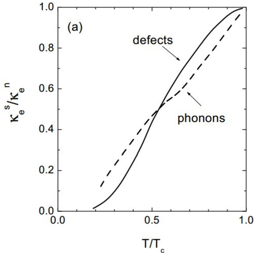
超伝導体( $T < T_c$ )では電子の熱伝導は絶対零度でゼロ。
