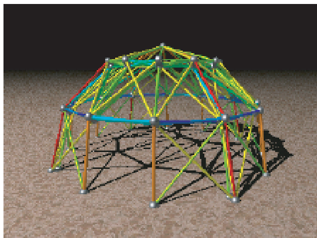
ダブルレアー・トラスドーム
