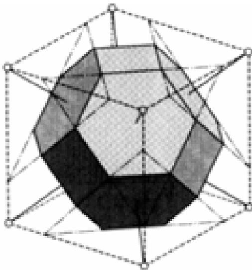
図5 bcc 格子のウィグナー・ザイツ胞
