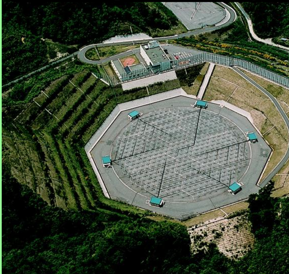
MUレーダー(46.5 MHz, 1 MW)
